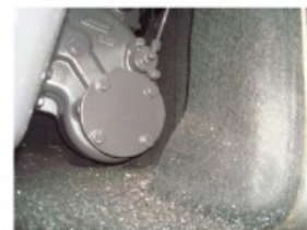
Tampa do flange da tomada de força do Scania P420
