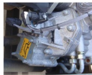
Tampa do flange da Tomada de força do MB ACTROS 4844
